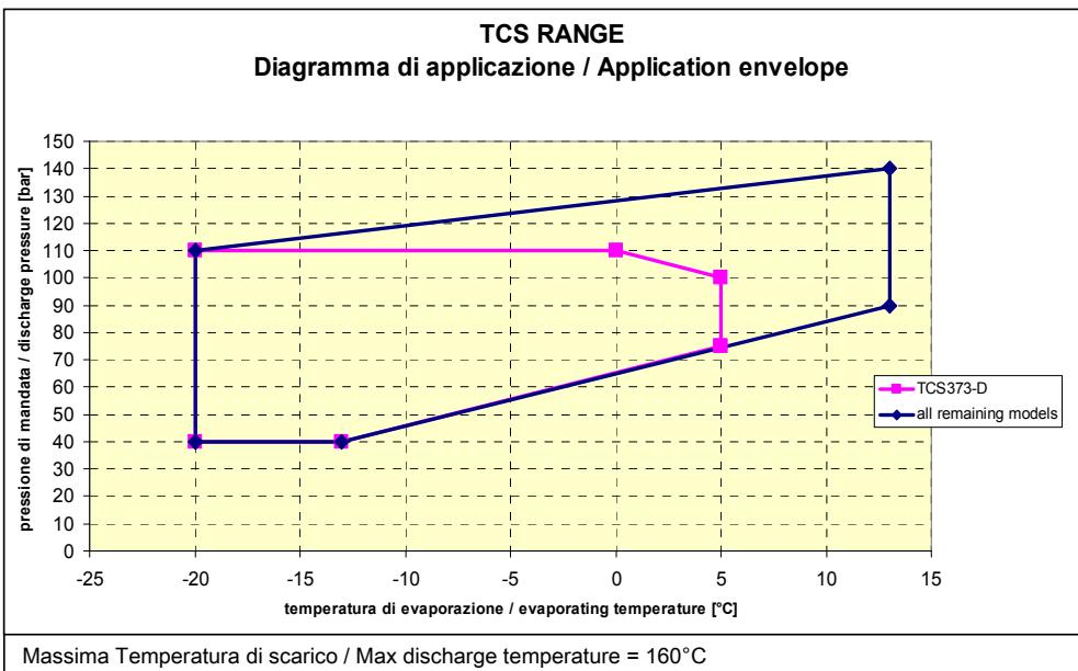
Per quanto riguarda i compressori transcritici è doveroso menzionare che i sistemi nei quali evocheranno non saranno dotati di condensatore, bensì di un gas cooler che raffredderà l'anidride carbonica compressa dalla macchina. Ne segue che la resa complessiva dell'impianto sarà fortemente influenzata da come viene ottimizzato lo scambiatore di alta pressione; più precisamente, al diminuire della temperatura di uscita dal gas cooler si assisterà ad un incremento della resa frigorifera.
