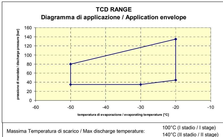
Per quanto riguarda i compressori transcritici è doveroso menzionare che i sistemi nei quali evocheranno non saranno dotati di condensatore, bensì di un gas cooler che raffredderà l'anidride carbonica compressa dalla macchina. Ne segue che la resa complessiva dell'impianto sarà fortemente influenzata da come viene ottimizzato lo scambiatore di alta pressione; più precisamente, al diminuire della temperatura di uscita dal gas cooler si assisterà ad un incremento della resa frigorifera.
